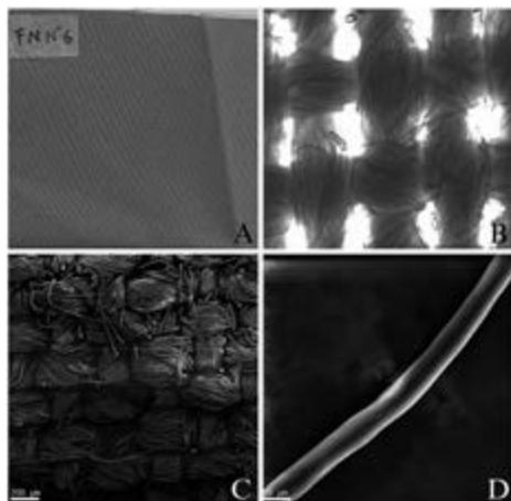
Nota. A- A simple vista, B- bajo MO (mag.:10X), C- Bajo MEB (mag.: 60X), D- Bajo MEB (mag.: 1000X). Elaboración propia.
