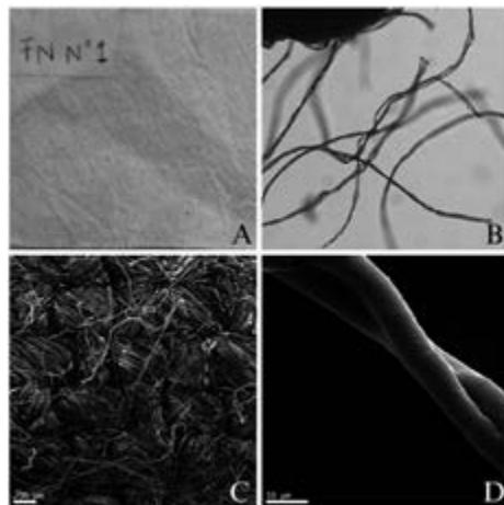
Nota. A- A simple vista, B- Bajo MO (mag.:10X), C- Bajo MEB (mag.: 40X), D- Bajo MEB (mag.: 1500X). Elaboración propia.
