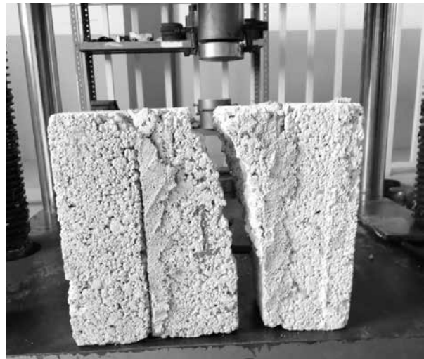
Figura 19. Ensayo de pila de adherencia falla mixta. Fuente: elaboración propia (2021).
