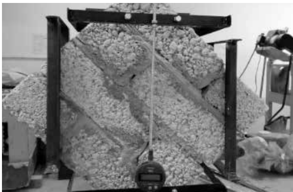
Figura 3. Instrumentación de murete.
