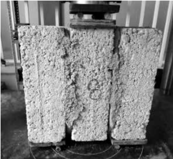
Figura 6. Instrumentación de pila de adherencia. Fuente: elaboración propia (2021).
