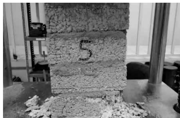
Figura 17. Ensayo de pila 5, falla por aplastamiento de pieza.
