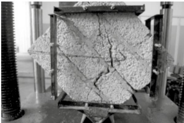
**Figura 14.** Ensaye de murete 7, falla por tensión diagonal.
