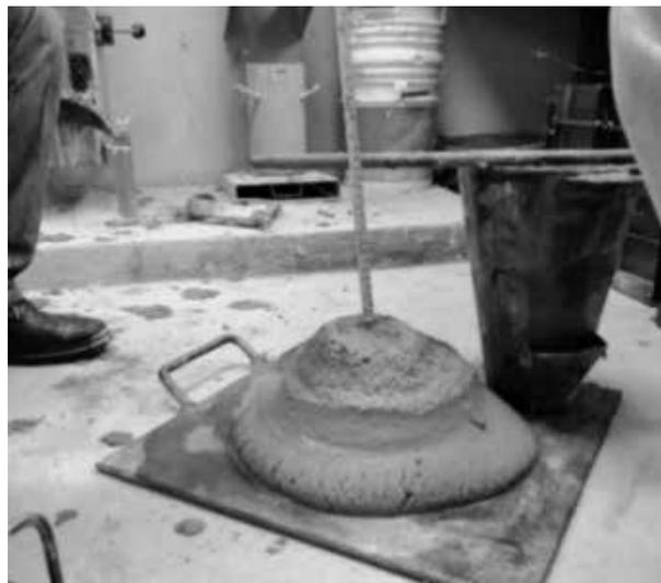
**Figura 9.** Prueba de revenimiento.
