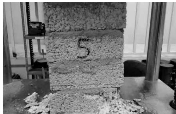
**Figura 17.** Ensayo de pila 5, falla por aplastamiento de pieza.
