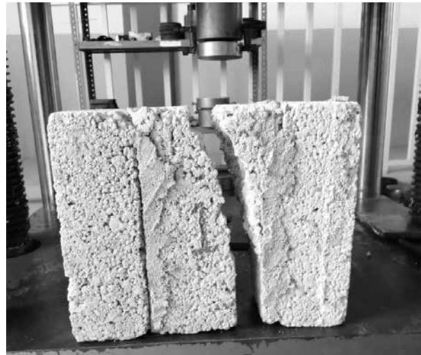
**Figura 19.** Ensayo de pila de adherencia falla mixta.
