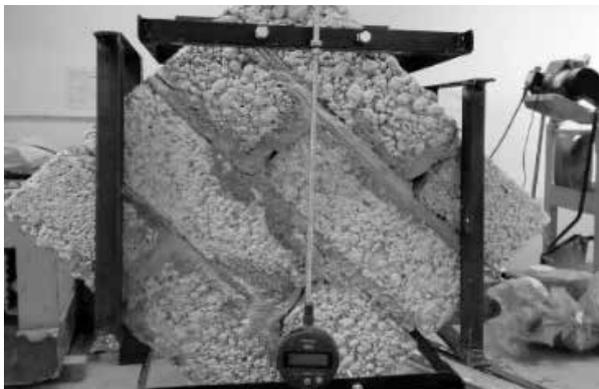
**Figura 3.** Instrumentación de murete.
